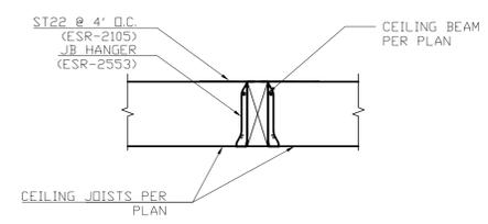
11 JOIST AND BEAM CONN. DETAIL
